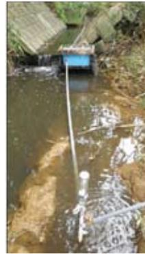
水路に設置した水撃ポンプ。試験的には650ml/分の汲み上げができるが、今後はさらに改良して安定した水の供給を目指す
